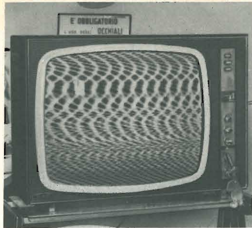
Fig. 13 - Il grid-dip usato per il controllo della catena di amplificazione video di un televisore.
