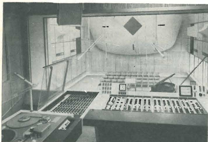
Una vista dello studio per le trasmissioni stereo; ogni elemento è duplice. Sul fondo si vedono i microfoni che nella trasmissione stereo devono essere piazzati con molta accuratezza.
