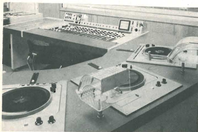
Pannello con monitori progettato dalla Technical Service della N. R. U. (Netherlands Radio Union). Si notano alcuni giradischi per la riproduzione di dischi stereofonici.
